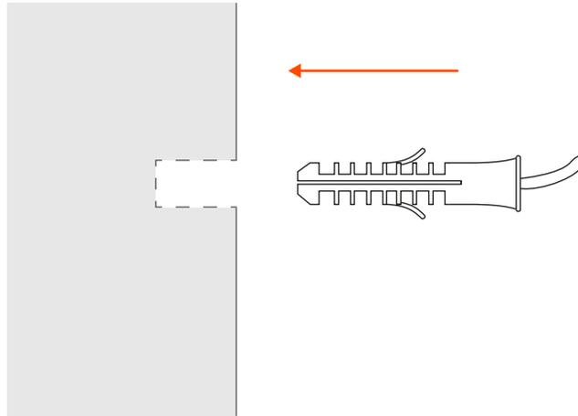
Inserire i fischer in dotazione nei fori precedentemente eseguiti nel muro
